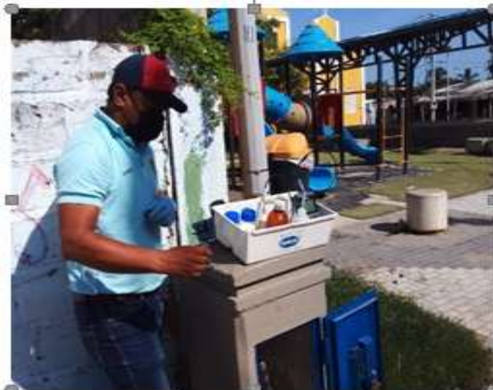
Toma de muestra de agua en el punto concertado del tanque de almacenamiento Mohan en Santa Ana de la red de distribución del acueducto.
